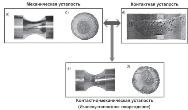
Рисунок 4 — Макроруревне: результат (в, д) необратимого взаимодействия повреждений (а, б) вала, обусловленных механической и контактной усталостью
