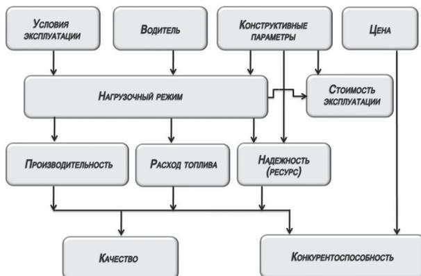
Рисунок 1 — Структура основных факторов, определяющих качество и конкурентоспособность мобильной машины
