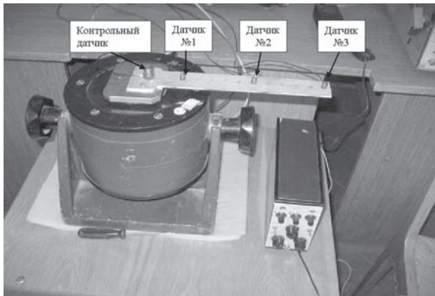
Рисунок 1 — Схема закрепления образца на вибростенде
