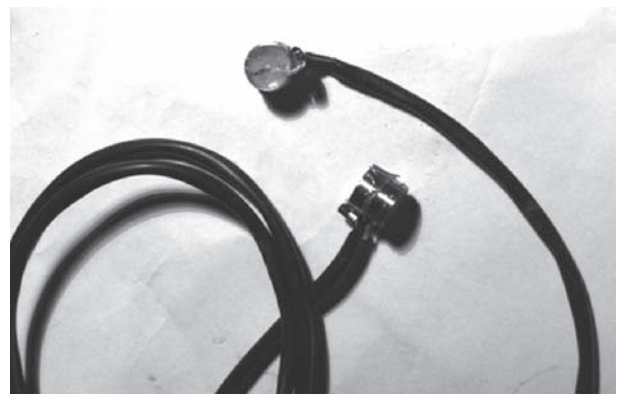
Рисунок 13 — Датчик регистрации изменения магнитной проницаемости металла при воздействии на него нагрузок
