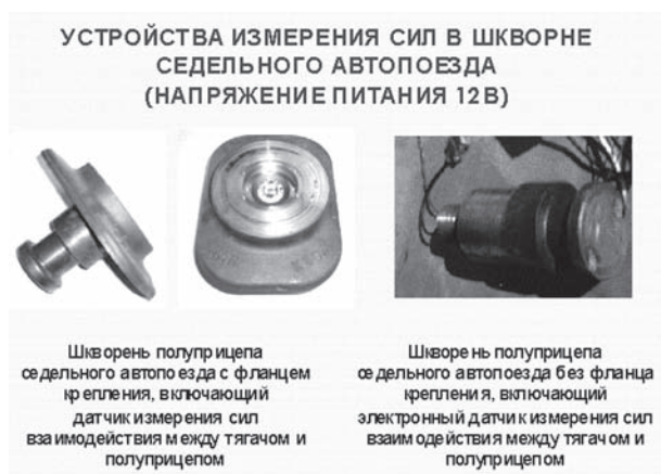
Рисунок 22 — Сцепные устройства седельных автопоездов с устройствами измерения сил между их звеньями
