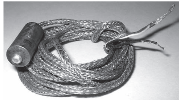
Рисунок 5 — Индукционные датчики измерения сил в опорах барабанных и в дисковых тормозных механизмах: а — бесконтактный индукционный датчик дифференцирования электрического сигнала, пропорционального скорости изменения разности реакции \frac{d(\Delta R)}{dt} = \frac{dM}{dt} ; б — контактный индукционный датчик измерения электрических сигналов пропорциональных силам в опоре колодок тормоза
