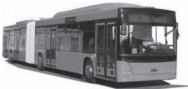
Рисунок 5 — Городской низкопольный автобус с гибридной трансмиссией
