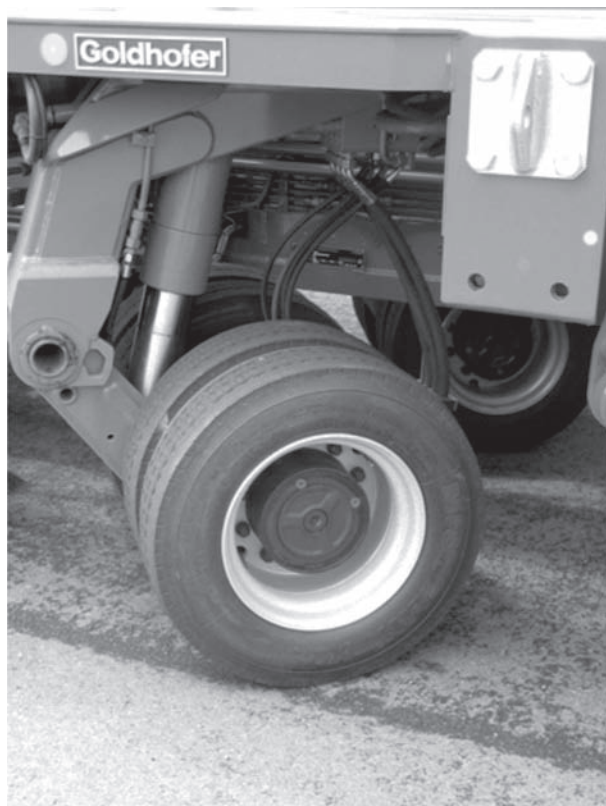
Рисунок 5 — Мехатронный колесный модуль:
