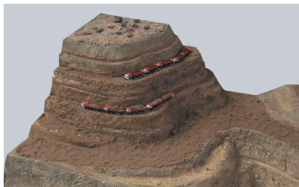
Рисунок 1 — Макет многозвенного самосвального автопоезда в условиях карьера с узкой бермой
