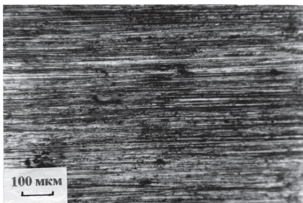
Рисунок 2 — Микроструктура поверхности трения закаленного образца сплава ХН77ТЮР после абразивного изнашивания ( $p = 0,02$  МПа)
