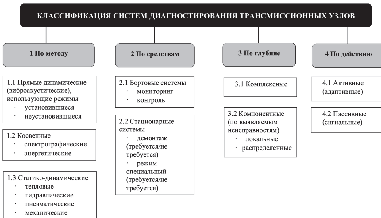
Рисунок 6 — Классификация систем диагностирования трансмиссионных узлов в эксплуатации
