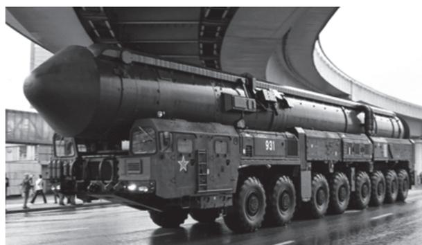
Рисунок 2 — СКШ МЗКТ-79221 в составе пусковой установки «Ярс»
