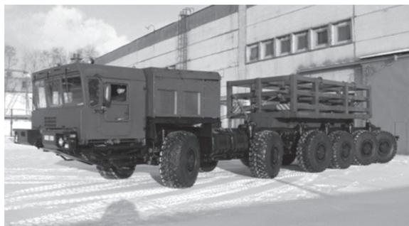
Рисунок 3 — СКШ МЗКТ-79291 на испытаниях
