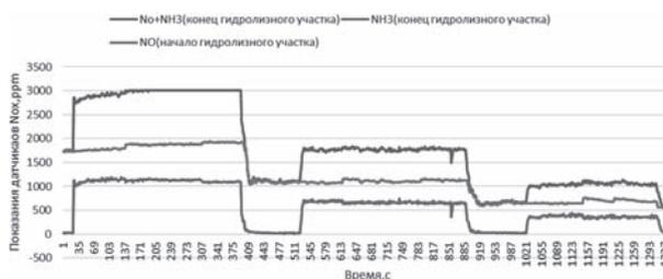
Рисунок 5 — Значения NO<sub>x</sub> и NH<sub>3</sub> на гидролизном участке
