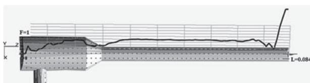
Рисунок 3 — Изменение скоростей и векторов движения частиц в смесительной камере и канале трубки
