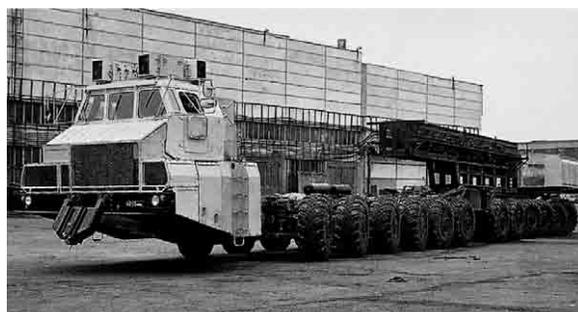
Рисунок 6 — Специальный колесный транспортер MAZ-7907 с электротрансмиссией и газотурбинным двигателем
