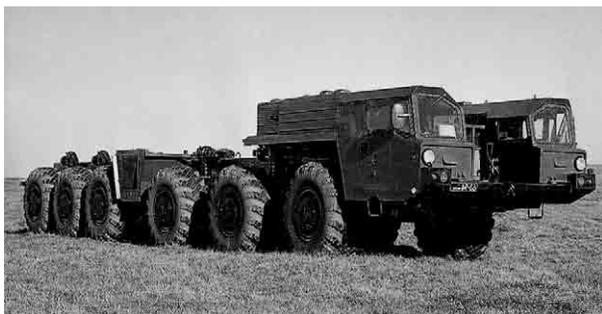
Рисунок 1 — Шестиосное шасси MAZ-547A [1]
