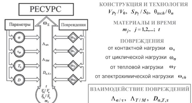
Рисунок 26 — Повреждаемость и ресурс механотермодинамической системы
