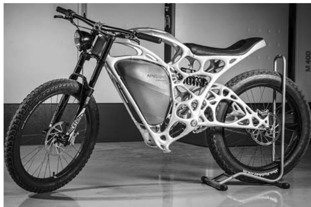
Рисунок 1 — Детали и конструкции, изготовленные методом 3D-печати: а — кронштейн крепления узла самолета A350 Airbus [7]; б — мотоцикл компании APWORKS (Airbus Group) [8]
