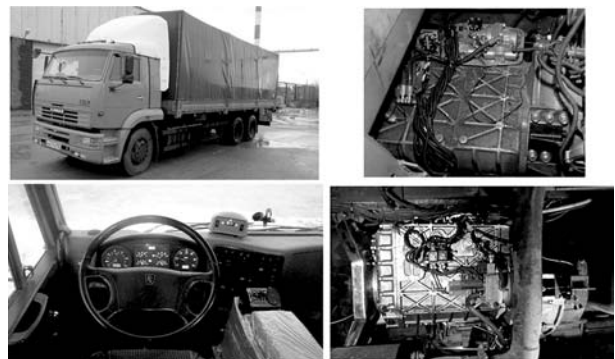
Рисунок 8 — Установка роботизированной трансмиссии ТМ16-2000 на автомобиле КамАЗ-65117
