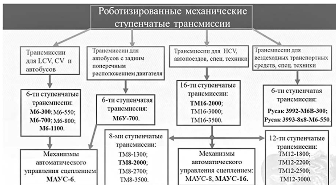
Рисунок 1 — Разработанные механические роботизированные ступенчатые трансмиссии
