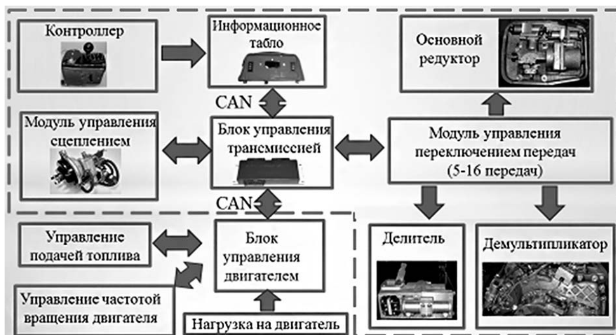
Рисунок 5 — Схема системы управления многоступенчатой трансмиссией
