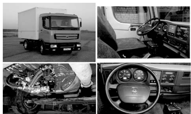
Рисунок 9 — Установка роботизированной трансмиссии М6-700 на автомобиле Русак-5354
