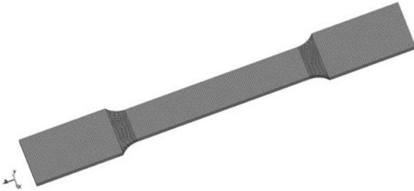
Рисунок 5 — Конечно-элементная модель образца
