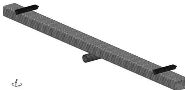
Рисунок 8 — Расчетная объемная модель балки  $60 \times 40 \times 3$  с элементами установки перед нагружением
