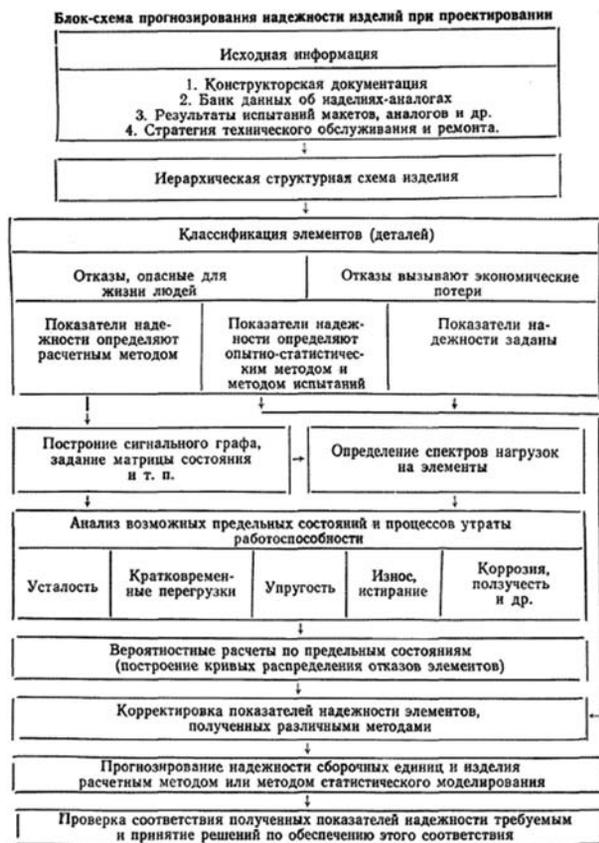
Рисунок 3 — Порядок прогнозирования надежности изделий при проектировании
