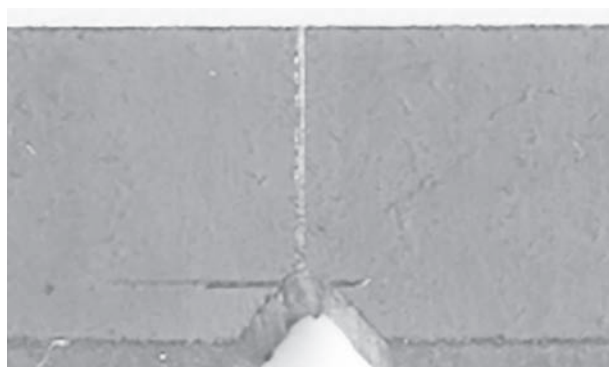
Рисунок 5 — Форма надреза образца ВТ23М для испытаний на ударную вязкость
