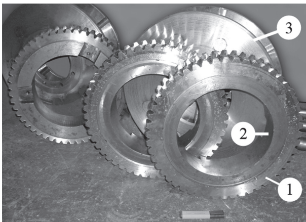
Рисунок 5 — Биметаллические венцы составных червячных колес с оснасткой для их изготовления: 1 — зубчатый профиль (бронза); 2 — основа (сталь); 3 — оснастка
