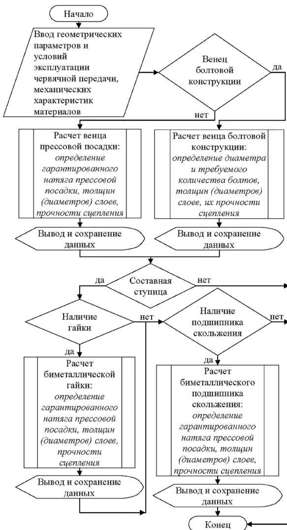
Рисунок 3 — Алгоритм расчета составного червячного колеса со сменными биметаллическими элементами
