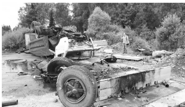
Рисунок 13 — Результаты натурных испытаний устройства остановки колесного транспорта на полигоне НИЦИАМТ ФГУП «НАМИ»
