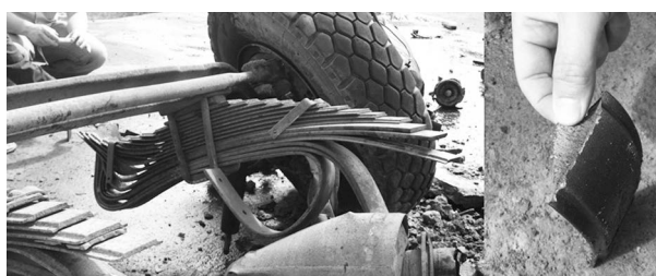
Рисунок 14 — Повреждения передних рессор автомобиля-самосвала КАМАЗ-5410 после столкновения с устройством остановки колесного транспорта
