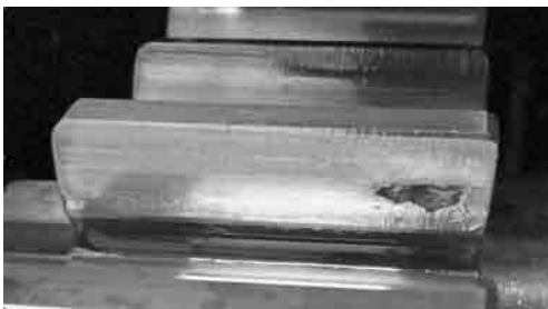
Рисунок 5 — Общий вид зубьев с глубинным контактным выкрашиванием зубчатого колеса из стали 20Х2Н4А после наработки на стенде 406 ч Figure 5 — General view of teeth with deep contact chipping of gears of steel 20Kh2N4A after bench running of 406 h
