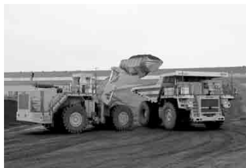
Рисунок 12 — Беспилотные самосвал БЕЛАЗ-7513R и погрузчик БЕЛАЗ-78250R на испытательном полигоне Figure 12 — Unmanned dump truck BELAZ-7513R and loader BELAZ-78250R at testing proving ground
