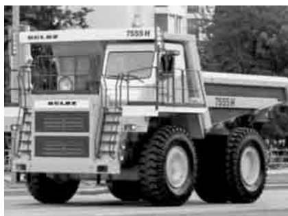
Рисунок 4 — Карьерные самосвалы БЕЛАЗ-75710 (а) и БЕЛАЗ-7555Н (b) грузоподъемностью 450 и 55 т соответственно Figure 4 — Mining dump trucks BELAZ-75710 (a) and BELAZ-7555H (b) with load capacity of 450 and 55 tons, respectively
