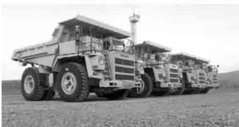
Рисунок 7 — Карьерные самосвалы БЕЛАЗ-75558 грузоподъемностью 90 т Figure 7 — Mining dump trucks BELAZ-75558 with load capacity of 90 tons
