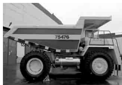
Рисунок 10 — Карьерный самосвал грузоподъемностью 45 т, работающий на сжиженном природном газе Figure 10 — Mining dump truck with load capacity of 45 tons, working on liquefied natural gas
