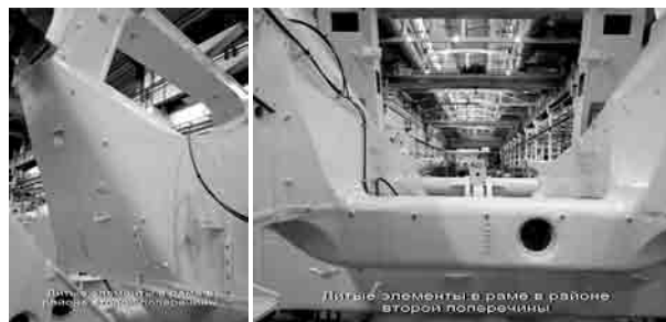
Рисунок 13 — Литосварные конструкции рам карьерных самосвалов БЕЛАЗ грузоподъемностью 130 т Figure 13 — Cast-welded structures of frames of BELAZ mining dump trucks with load capacity of 130 tons
