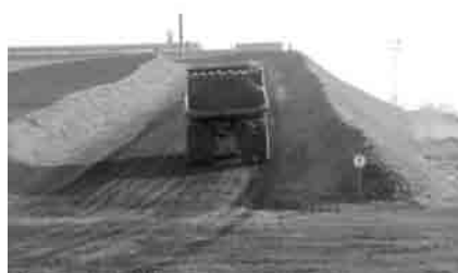
Рисунок 9 — Заводские стендовые (a) и полигонные (b) площадки испытаний и доводки уникальных агрегатов и новых моделей карьерных самосвалов
