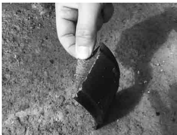
Рисунок 8 — Повреждения передних рессор автомобиля-самосвала КАМАЗ-5410 после столкновения с устройством остановки колесного транспорта Figure 8 — Damage to front springs of truck KAMAZ-5410 after collision with stopping device of wheel transport
