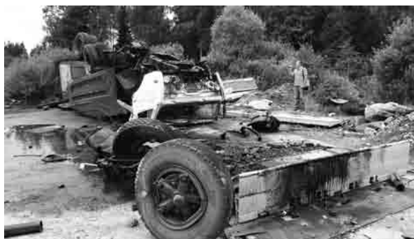
Рисунок 7 — Результаты натурных испытаний устройства остановки колесного транспорта на полигоне НИЦИАМТ ФГУП «НАМИ»
