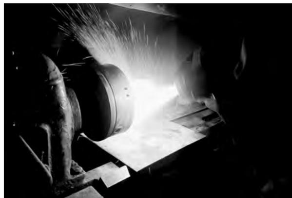
Рисунок 4 — Процесс гиперзвуковой металлизации образцов
