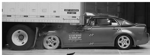
Рисунок 1 — Фрагмент из видео испытаний ЗПЗУ страховым институтом дорожной безопасности (IIHS).
