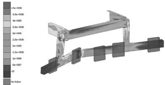
Рисунок 10 — Результаты виртуальных испытаний первоначальной конструкции ЗПЗУ (вариант 1). Картина распределения напряжений, потеря устойчивости при нагружении в точке  $P_1$
