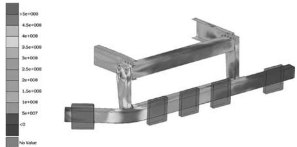
Рисунок 12 — Результаты виртуальных испытаний усиленного варианта конструкции (вариант 2). Картина распределения напряжений, потеря устойчивости при нагружении в точке  $P_3$
