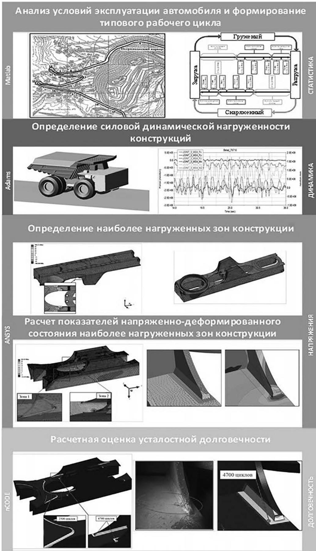
Рисунок 1 — Алгоритм расчета долговечности несущих конструкций на основе комплексного компьютерного моделирования процессов
