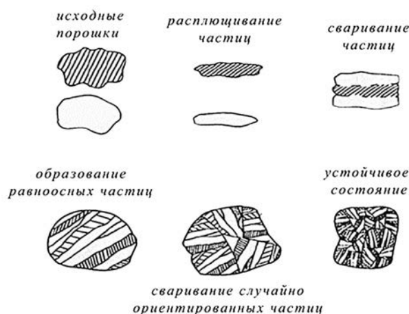
Рисунок 1 — Схема образования композитных частиц из смеси разнородных порошков, находящейся между размольными шарами [14]
