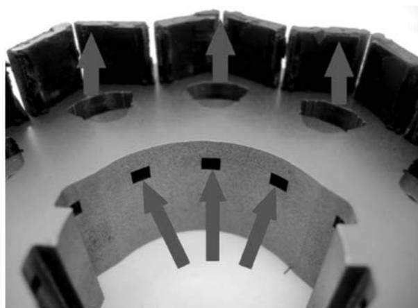
Рисунок 3 — Охлаждение ротора МГ Toyota Prius (стрелками показаны направления движения жидкости из вала (см. рисунок 2) по каналам внутри ротора в зоны расположения постоянных магнитов [10])
