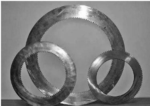
Рисунок 2 — Фрикционные диски с наружным и внутренним зубчатым (шлицевым) венцом
