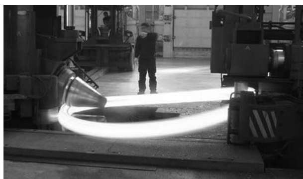
Рисунок 1 — Искажение маложесткого кольца при кольцераскатке
