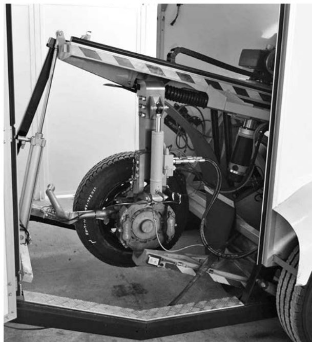
Рисунок 3 — Схема дорожной лаборатории для исследования динамических характеристик шин: 1 — исследуемая шина; 2 — нижний рычаг; 3 — верхний рычаг; 4 — электрогидравлический привод угла увода; 5 — электрогидравлический привод вертикальной силы на колесе; 6 — балласт
