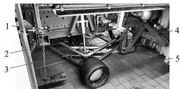
Рисунок 2 — Стенды для испытания шин: a — стационарный [17]; b — дорожный [19]; 1 — гидравлическая подвеска; 2 — ось; 3 — рама; 4 — поворотный актуатор; 5 — тестируемая шина с датчиком силы
