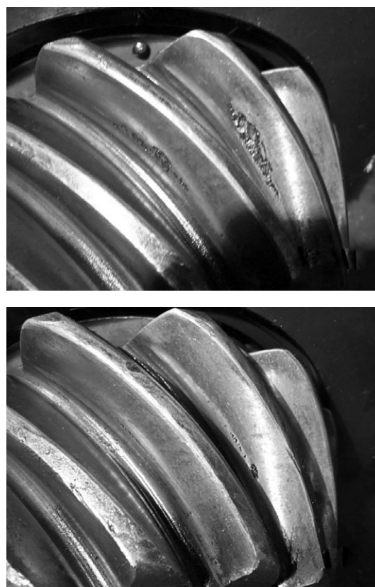
Рисунок 9 — Состояние зубьев ведущей шестерни главной передачи Figure 9 — Teeth condition of the main gear drive gearwheel
