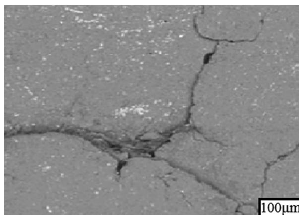
Рисунок 5 — Микротрещины в поверхностном слое наружного крупногабаритного кольца подшипника Figure 5 — Microcracks in the surface layer of the large-sized outer bearing ring
