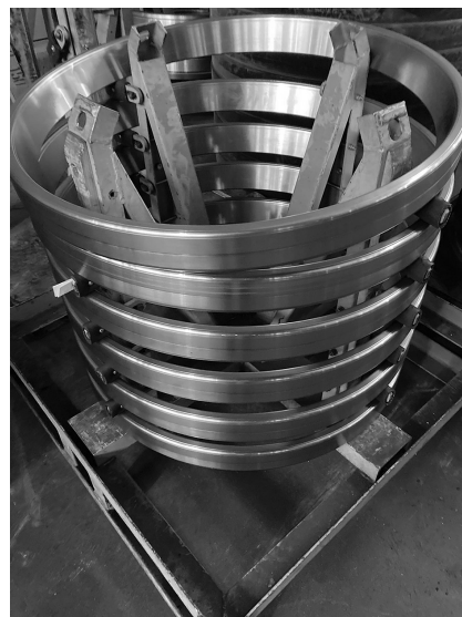
Рисунок 1 — Общий вид наружных крупногабаритных колец подшипников из стали 20Х2Н4А
