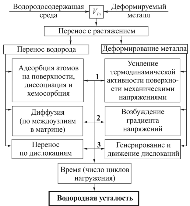
Рисунок 7 — Основные механизмы обратного эффекта, связанные с водородной усталостью Figure 7 — Main mechanisms of the reverse effect associated with hydrogen fatigue
