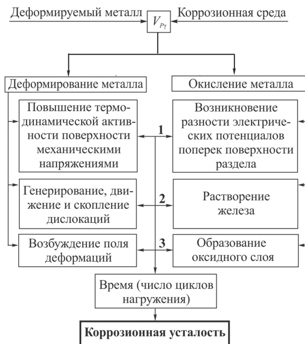
Рисунок 4 — Циклическое деформирование металла в пределах опасного объема V_{Pr} Figure 4 — Cyclic deformation of metal within the dangerous volume V_{Pr}
