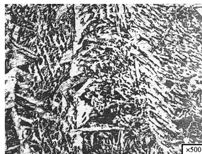
Рисунок 9 — Микроструктура сварного шва образца сварного соединения из стали 10ХСНД в исходном состоянии Figure 9 — Welded seam microstructure of the sample welded joint made of 10KhSND steel in the initial state
