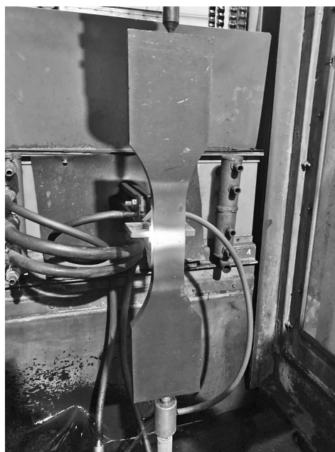
Рисунок 1 — Общий вид процесса скоростной электротермической обработки образца со сварным соединением на основе низколегированной конструкционной стали 10ХСНД Figure 1 — General view of the process of high-speed electrothermal treatment of a sample with a welded joint on the basis of low-alloy structural steel 10KhSND
