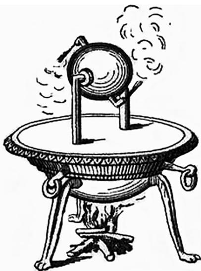
Рисунок 1 — Простейшая паровая турбина «Шар бога ветров Эола» [1]
