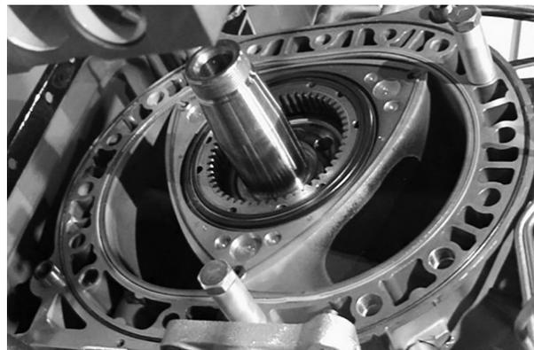
Рисунок 4 — Двигатель Ванкеля
