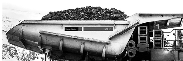
Рисунок 1 — Инновационные кузова карьерных самосвалов: a — Duratray SDB для самосвала CAT 796AC [28]; b — Hercules EXO [29]; c — High Performance Truck Tray [30]; d — MTB 171 [31] Figure 1 — Innovative dump truck bodies: a — Duratray SDB for CAT 796AC dump truck [28]; b — Hercules EXO [29]; c — High Performance Truck Tray [30]; d — MTB 171 [31]
