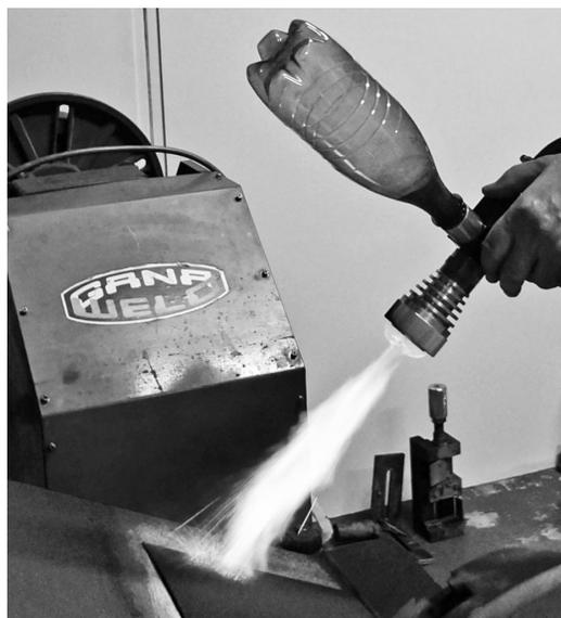
Рисунок 1 — Термораспылитель ОИМ 050 в работе
