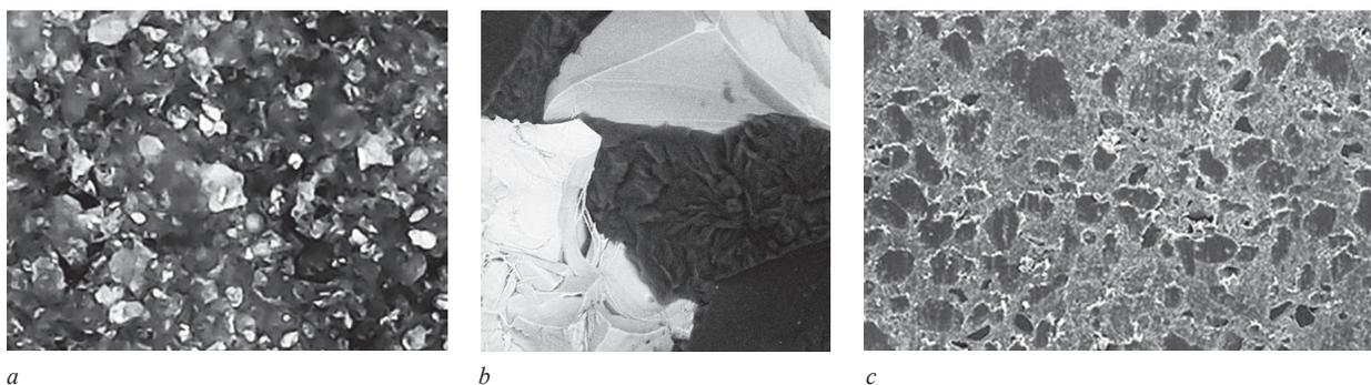
Рисунок 6 — Вид поверхности покрытия с частицами электрокорунда (a, b) и структура покрытия с 40 об.% карбида бора (c): оптический микроскоп (a, c —  $\times 200$ ), сканирующий электронный микроскоп (b —  $\times 1500$ )
