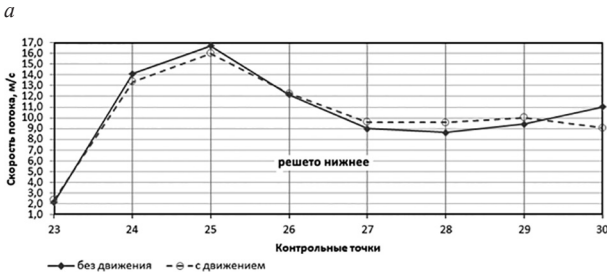
Рисунок 8 — Распределение скоростей потока в проточной области: a — над стрясной доской, верхним решетом и удлинителем т.1...т.22; b — над нижним решетом т.23...т.30 Figure 8 — Flow velocity distribution in the flow area: a — above the shaking board, upper screen and extension t.1...t.22; b — above the lower screen t.23...t.30
