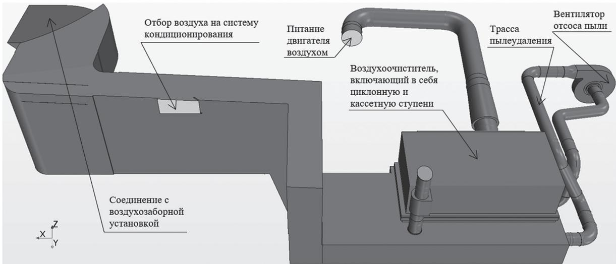
Рисунок 1 — Расчетная модель базовой системы питания двигателя воздухом
