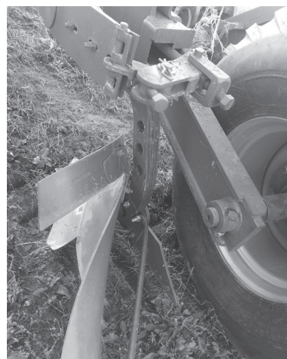
Рисунок 9 — Грядиль плуга ПО-(4+1)-40 с модифицированной конструкцией во время полевых испытаний Figure 9 — Beam of the plow PO-(4+1)-40 with modified design during field testing
