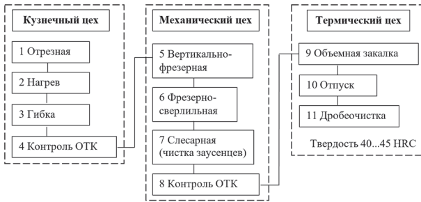
Рисунок 2 — Структурная схема традиционного технологического процесса изготовления грядиля на МЗШ Figure 2 — Structural diagram of the traditional technological process of beam manufacturing at OJSC “Minsk Gear Works” (MGW)
