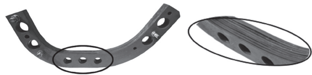
Рисунок 5 — Пакет листовых выкроек грядиля с модифицированной конструкцией Figure 5 — Pattern sheets package of the beam with modified design
