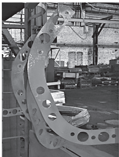
Рисунок 7 — Листовые выкройки грядиля на участке покраски в механическом цехе МЗШ Figure 7 — Pattern sheets of the beam at the painting area in the MGW mechanical shop
