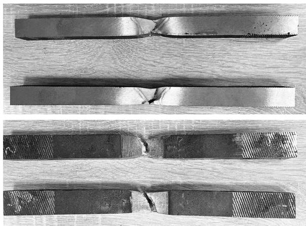
Рисунок 5 — Общий вид разрушенных после растяжения образцов со сварным соединением из стали 10ХСНД, микролегированных ванадием
