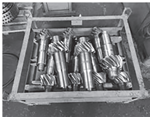
Рисунок 3 — Партия деталей «Шестерня ведущая» главной передачи карьерного самосвала из перспективной стали 20ХНЗФА
