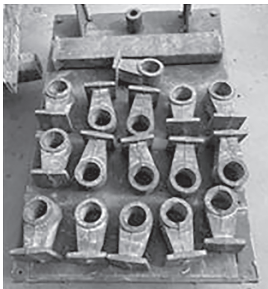
Рисунок 19 — Чугунные отливки: «Корпус» и «Подкладка», полученные из пылевидных железосодержащих отходов Figure 19 — Cast iron castings: “Casing” and “Lining” obtained from pulverized iron-containing waste
