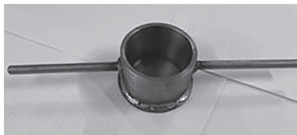
Рисунок 18 — Внешний вид оснастки для изготовления брикетов методом холодного формования Figure 18 — Appearance of tooling for briquette production by the cold molding method
