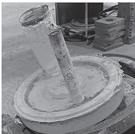
Рисунок 16 — Экспериментальная толстостенная отливка «Кольцо» из ИЧХ Figure 16 — Experimental thick-walled “Ring” casting made of the ИЧХ (IChKh) cast iron
