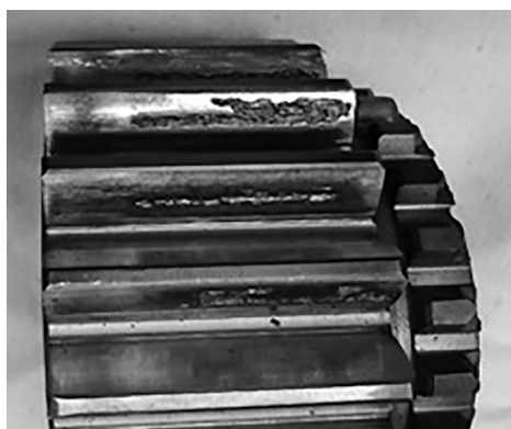
Рисунок 3 — Вид шестерни из стали 20ХН3А после стендовых испытаний в объеме 300 ч (объект 2) Figure 3 — View of a gear made of 20KhN3A (20KhN3A) steel after 300 h of bench testing (object 2)
