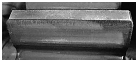
Рисунок 8 — Вид зуба шестерни из стали 21ХГНМБА после 700 ч стендовых испытаний (объект 7) Figure 8 — View of a gear tooth made of 21KhGNMBA (21KhGNMBA) steel after 700 h of bench testing (object 7)
