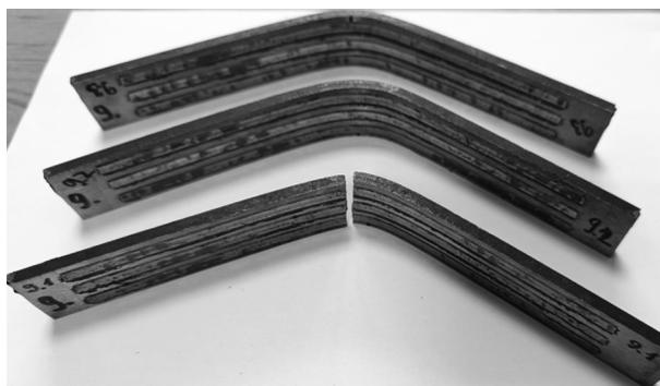
Рисунок 9 — Образцы серии 9 после испытаний
