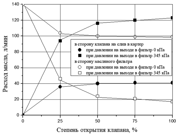
Рисунок 14 — Среднее значение расхода масла при различных степенях открытия клапана регулировки давления и область ориентировочных значений расхода масла в фильтр при различных значениях давления масла на выходе из крышки маслоохладителя в сторону масляного фильтра
