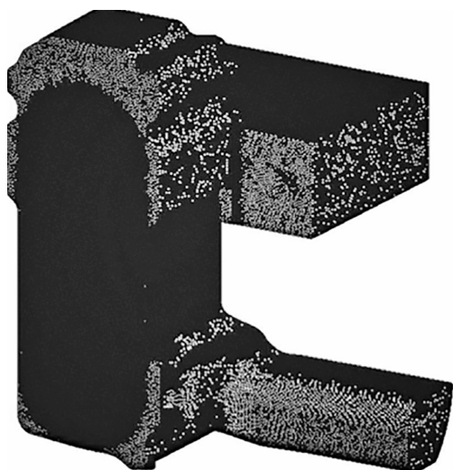
Рисунок 7 — Фрагменты расчетной сетки маслоохладителя Figure 7 — Fragments of the calculation grid of the oil cooler
