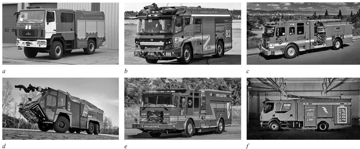
Рисунок — Современные пожарные автомобили: а — АЦ 5,0-40 на шасси МАЗ-5309 (дизель, Беларусь); б — Rosenbauer RT/RTX (последовательный гибрид, Австрия и Германия) [11–13]; в — Pierce Volterra (параллельный гибрид, США) [16–18]; д — Ziegler Z6 HYBRIDdrive (гибрид аэродромного назначения, Германия) [22, 23]; е — E-ONE Vector (полностью электрический, США) [19];
