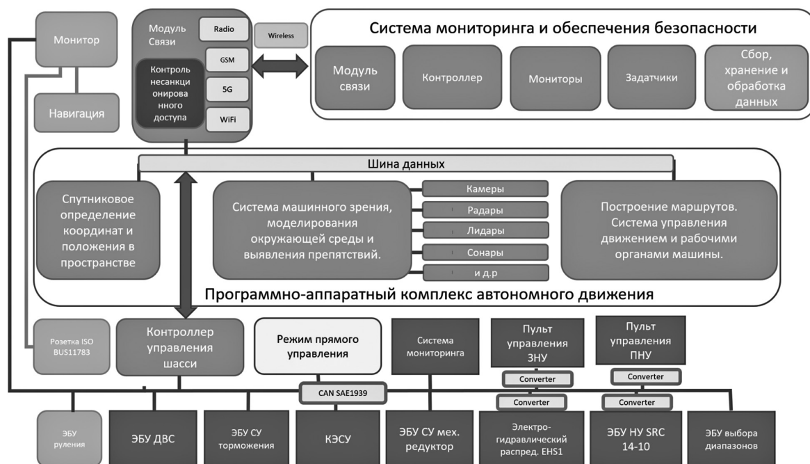
Рисунок 1 — Структура системы управления макетным образцом робототехнического комплекса на базе трактора BELARUS 3522
