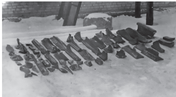
Рисунок 3 — Пример мощного турбогенератора (а) и катастрофического разрушения рельсов (б) Figure 3 — Example of a powerful turbo generator (а) and catastrophic destruction of rails (b)
