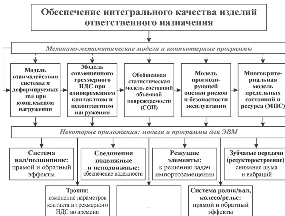
Рисунок 6 — Методология последовательной постановки и решения задач трибофатики Figure 6 — Methodology of consistent formulation and solution of tribo-fatigue problems
